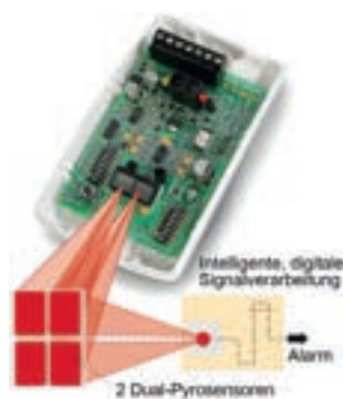
DUO-PIR-Technologie Zwei unabhängige Dual-Infrarot-Sensoren
