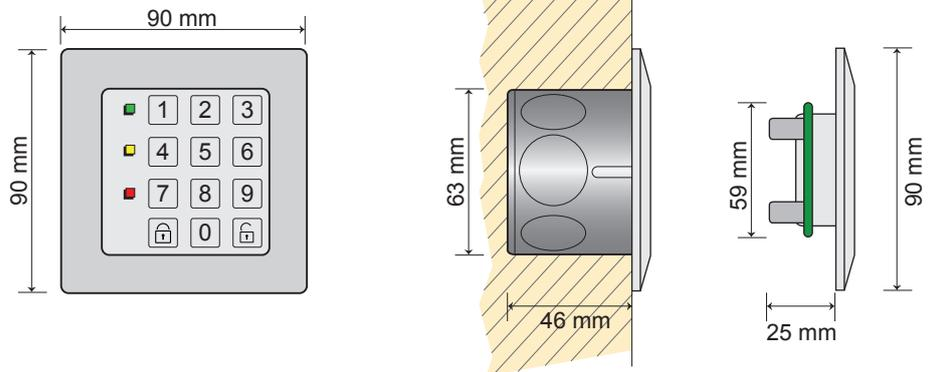
**Einbau-Ausführung für Schalterprogramme**
