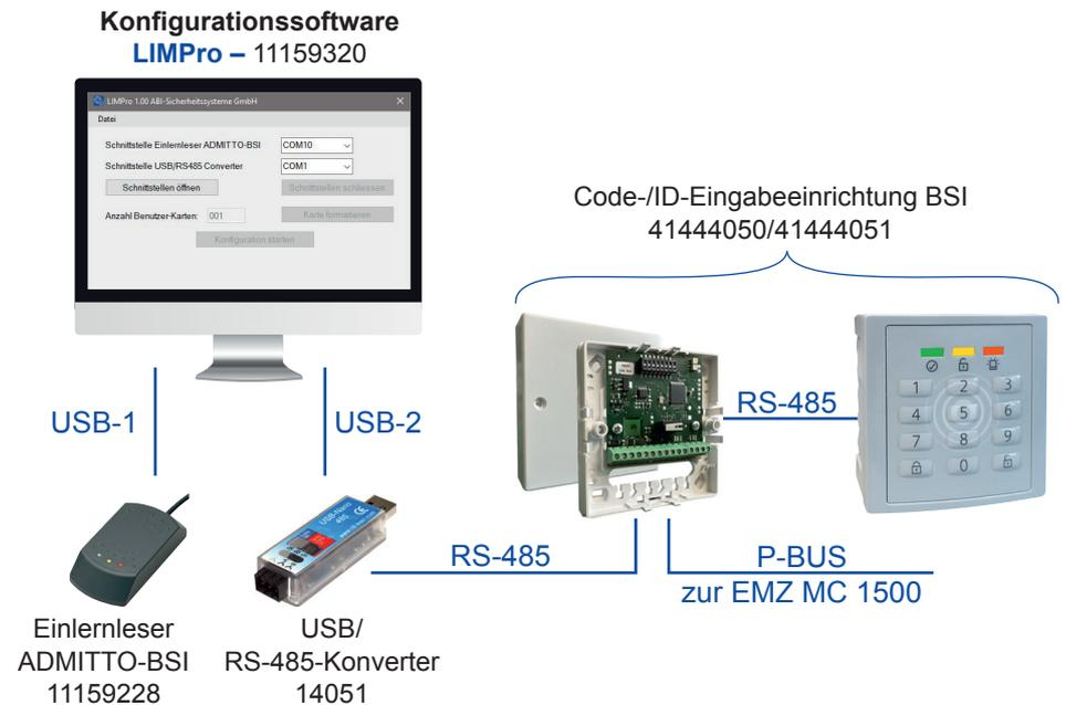
Die Parametrierung und Konfiguration muss gem. BSI am Einsatzort im gesicherten Bereich erfolgen. Die Parametrierung und Konfiguration ist nur für jeweils ein System gültig und kann nicht auf andere Systeme übertragen werden.
