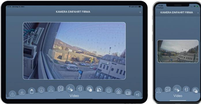
Mit Video werden die Funktionalitäten zur Anzeige von Live-Bildern von bis zu 16 Kameras erweitert. Die Auswahl der Kameras kann über die Funktionsauswahl bzw. direkt in einer Grafik bzw. direkt in einem Plan erfolgen.
