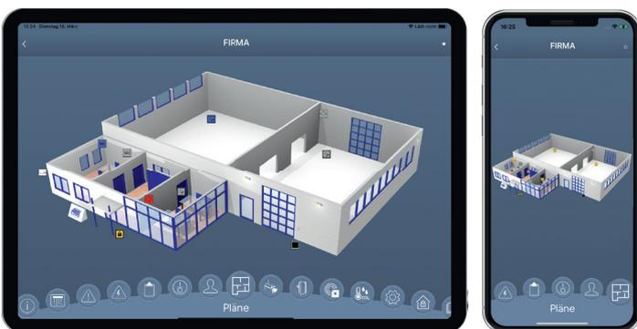
Mit Grafik/Pläne werden die Funktionalitäten zur Visualisierung von Grafiken (z.B. Grundrissplänen) erweitert. In den Grafiken können dann einfach, per Drag und Drop, Anzeige/Bedienelemente frei platziert werden.
