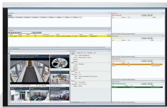
In diesem Beispiel zeigt der linke Bildschirm die Graphiken (Gebäudegrundrisse, Einsatzpläne, etc.), der rechte Bildschirm listet alle Ereignisse (Alarmermeldungen, Störungen, Melderabschaltungen, etc.) in entsprechenden Listen auf und kann zusätzlich bis zu 6 Videobilder gleichzeitig anzeigen. Dies bietet dem Benutzer die Möglichkeit, zeitgleich sowohl den Gebäudeplan des zu überwachenden Objektes als auch die zugehörigen Informationen zu überblicken.
